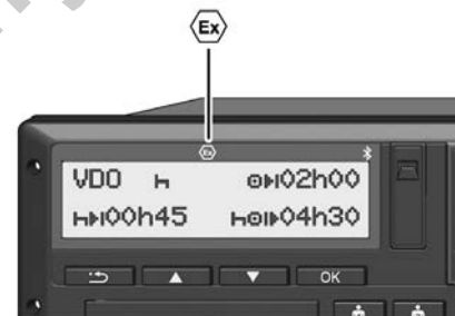
Fig. 2: Simbol pentru rezistența la explozii pe partea frontală
